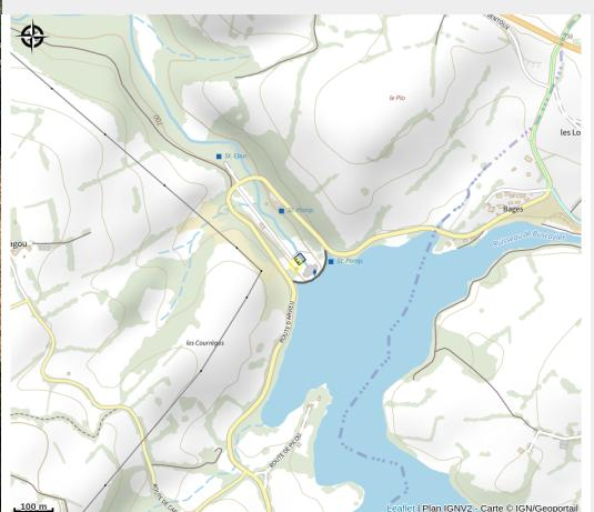
Le barrage de Bage et son usine de pompage servent de trait d'union entre les lacs de Pareloup et celui de Pont-de-Salars. Cette installation fait partie du complexe hydroélectrique du Pouget aux côtés de 8 autres barrages.
